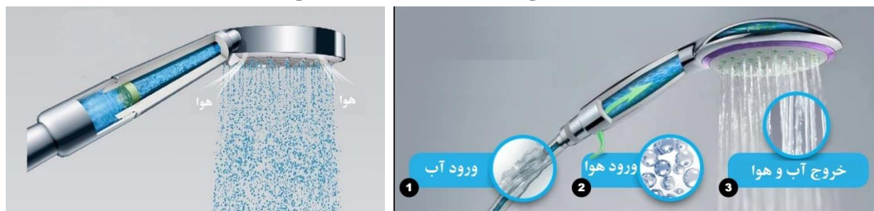
شکل ۲۶: اختلاط آب و هوا در سردوش کاهنده مصرف آب
