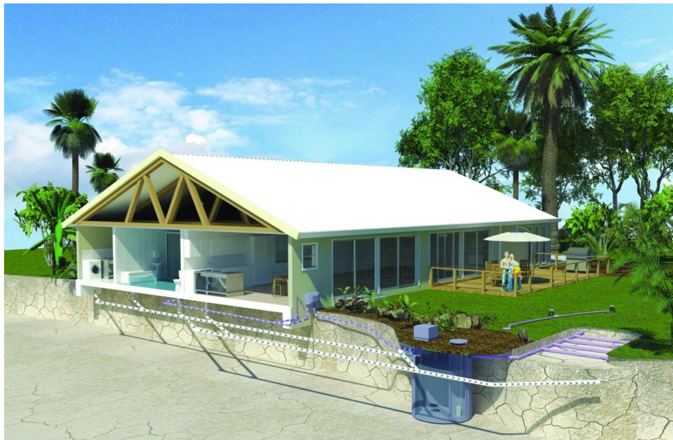
شکل ۲۲: سیستم بازچرخانی آب خاکستری در منزل مسکونی برای آبیاری فضای سبز
