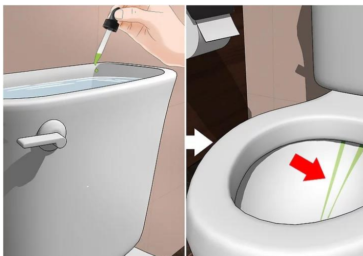
نحوه تشخیص نشت آب از فلاش تانک با استفاده از ماده رنگی
