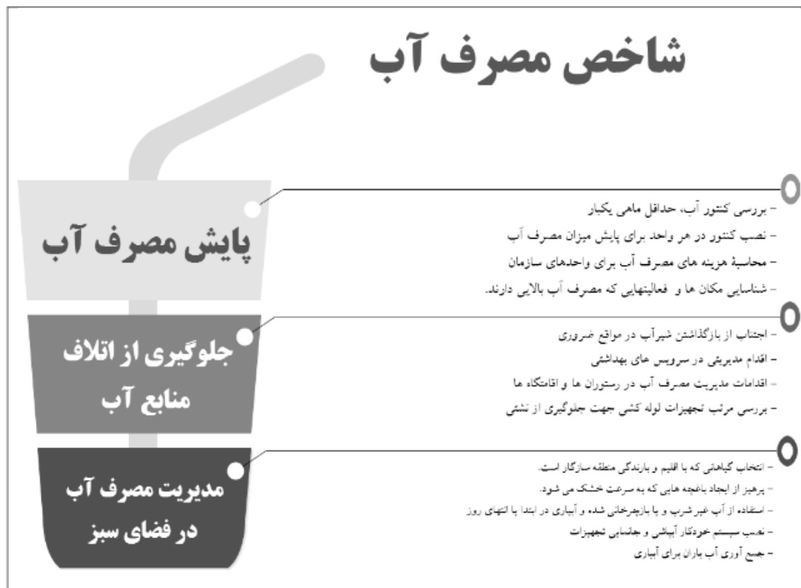
شکل ۴: اقدامات اجرایی شاخص مصرف آب
