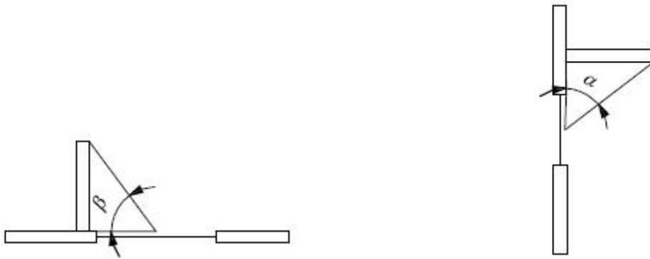
نمایش زاویه سایه‌بان عمودی (overhang)
